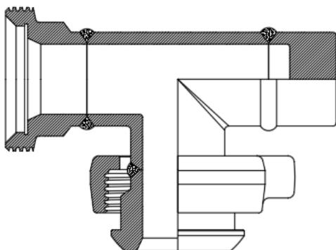
ADITA posee banco de prueba hidráulica preparado para realizar la certificación de las TE en caso de ser solicitado. Las mismas serán identificadas mediante marcación de puntos así también como con fleje de acero inoxidable. Los mismos indican la presión de trabajo, tipo de conexión, combinación, fecha de fabricación y N° de serie para trazabilidad.
